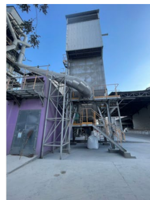
การปรับปรุงระบบกำจัดฝุ่นภายในโรงงานด้วยระบบ Bag House Filter ซึ่งเป็นระบบควบคุมฝุ่นแบบแห้ง เพื่อลดการใช้น้ำแทนระบบกำจัดฝุ่นแบบเปียก Wet Scrubber
