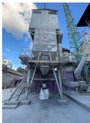
การปรับปรุงระบบกำจัดฝุ่นภายในโรงงานด้วยระบบ Bag House Filter ซึ่งเป็นระบบควบคุมฝุ่นแบบแห้ง เพื่อลดการใช้น้ำแทนระบบกำจัดฝุ่นแบบเปียก Wet Scrubber
